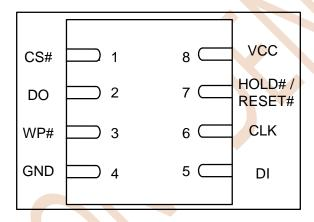
Figure 3.2 DFN8 (5\*6 mm)
