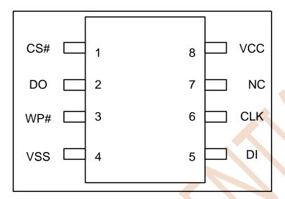
Figure 3.1 SOP8 (150/208mil)/ DIP8 (300mil)
