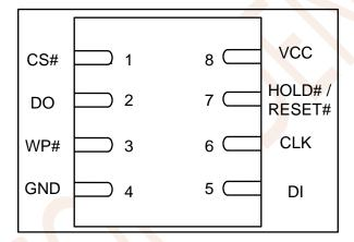
Figure 3.2 DFN8 (5\*6 mm)
