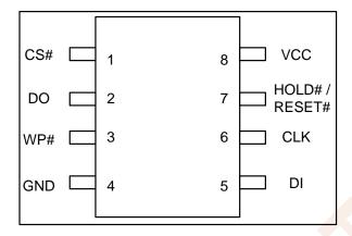
Figure 3.1 SOP8 (150/208mil)/ DIP8 (300mil)
