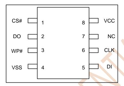
Figure 3.1 SOP8 (150/208mil)/ DIP8 (300mil)
