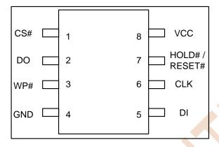
Figure 3.1 SOP8 (150/208mil)/ DIP8 (300mil)
