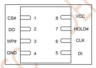
Figure 3.2 DFN8 (5\*6 mm)
