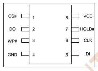
Figure 3.1 SOP8 (150/208mil)/ DIP8 (300mil)
